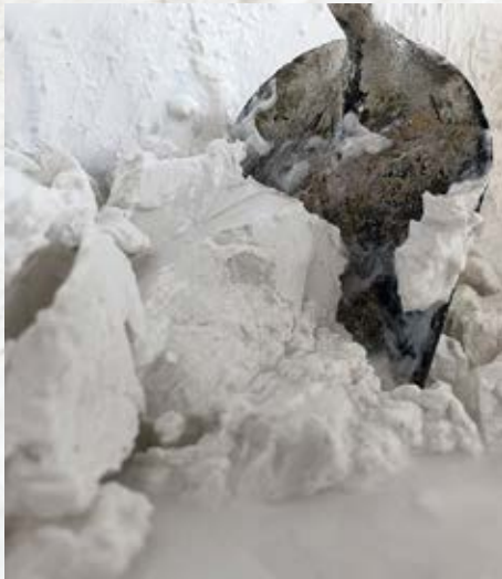
Industriell mit Wasser gelöschter Kalk wird auch «Sumpfkalk» genannt.
