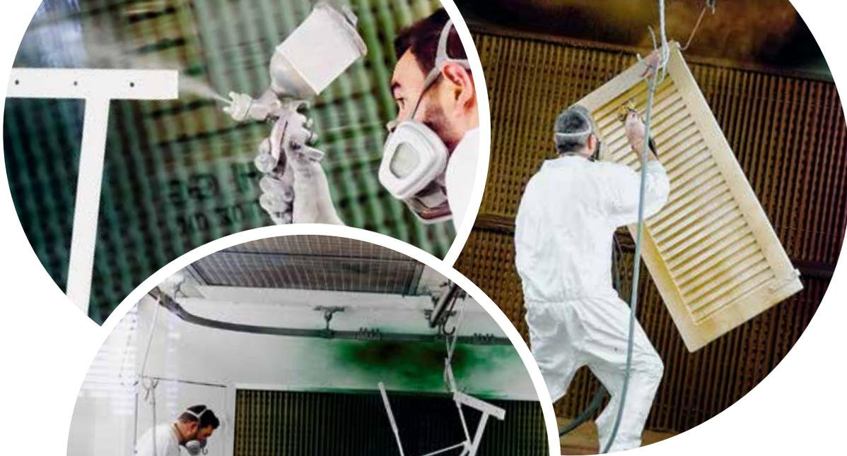
**Grundieren.** In einer der beiden Spritzkabinen erhalten die Metallteile eine Grundierung. So haftet die Farbe besser und bereitet noch lange Freude.
