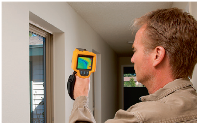
Die Wärmebildkamera zeigt, wo Temperaturunterschiede bestehen, die einen Schimmelpilzbefall begünstigen können.
